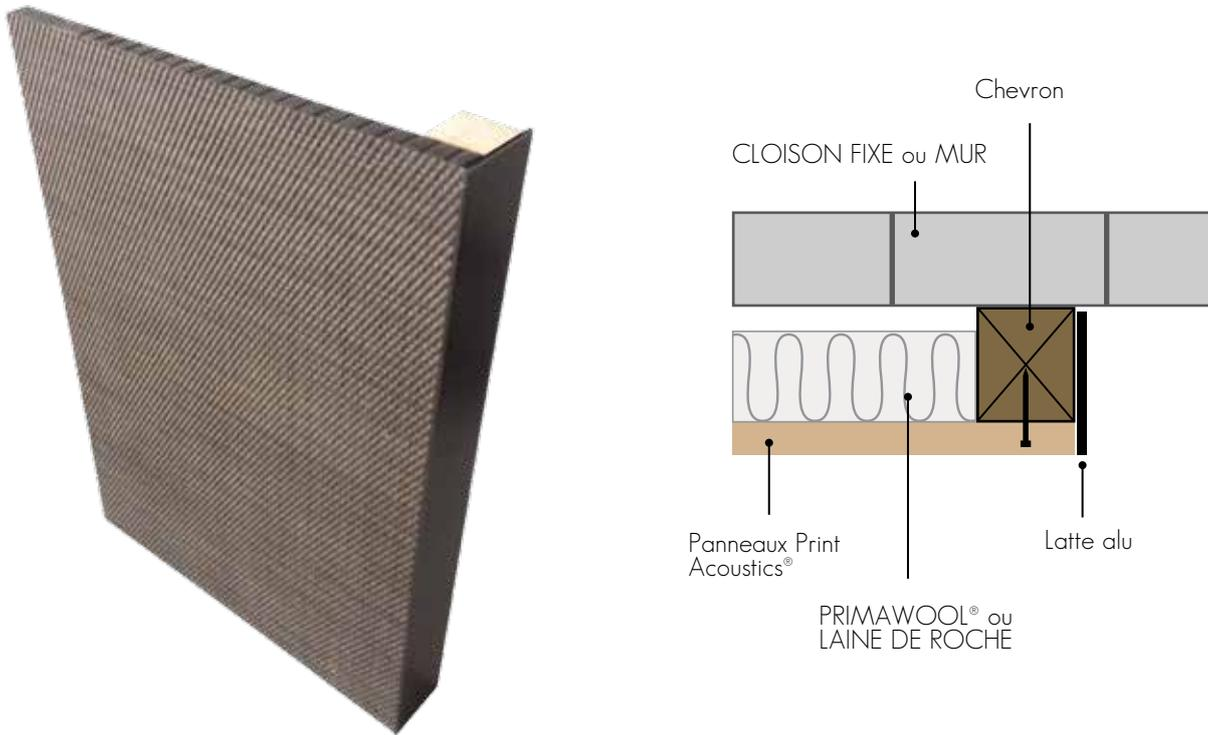
fig 21. Exemple avec latte alu - TYPE I
